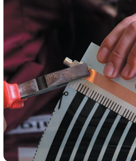
Рис. 10. Крепление контактного зажима к термопленке
