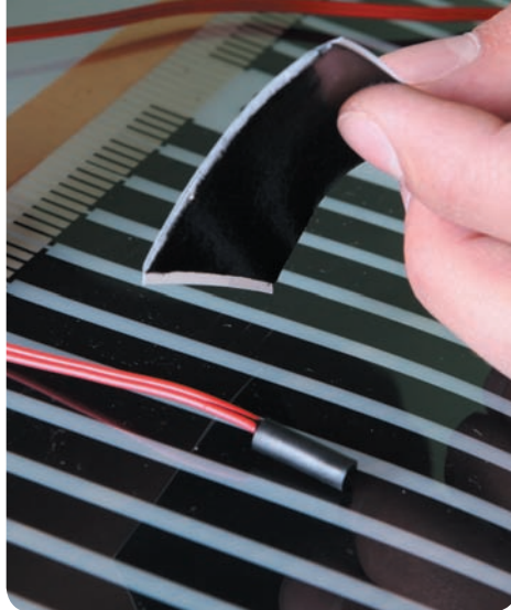
Рис. 24. Датчик прикрепляется к термолентке битумной изоляцией
